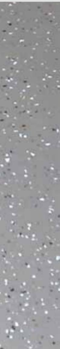
Gussasphalt ist ein hohlraumfreies und dichtes Gemisch aus Füller (Gesteinsmehl), Sand, Splitt und Bitumen.
